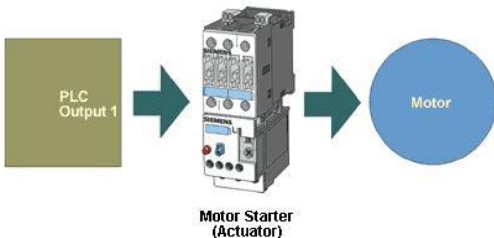
Hình 14.13 Điều khiển qua ngõ ra PLC
