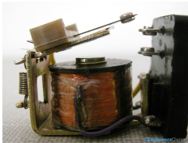
Hình 6.2 Bên trong một Rơ le điện từ kiểu bản lề
