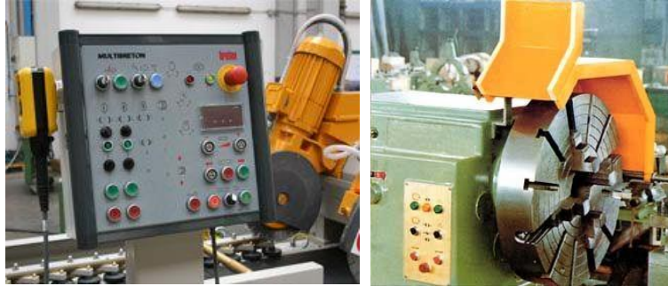
Hình 5.11 Bảng điều khiển sử dụng Nút nhấn trên các máy công cụ
